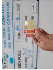
ชุดทดสอบค่าความเป็นกรด - ด่าง (pH) และคลอรีนสระว่ายน้ำ
